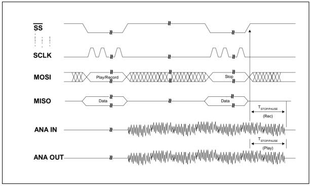
FIGURE 8: PLAYBACK/RECORD AND STOP CYCLE
